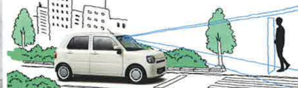
■上図はステレオカメラが前方の歩行者を検知しているイメージです。
